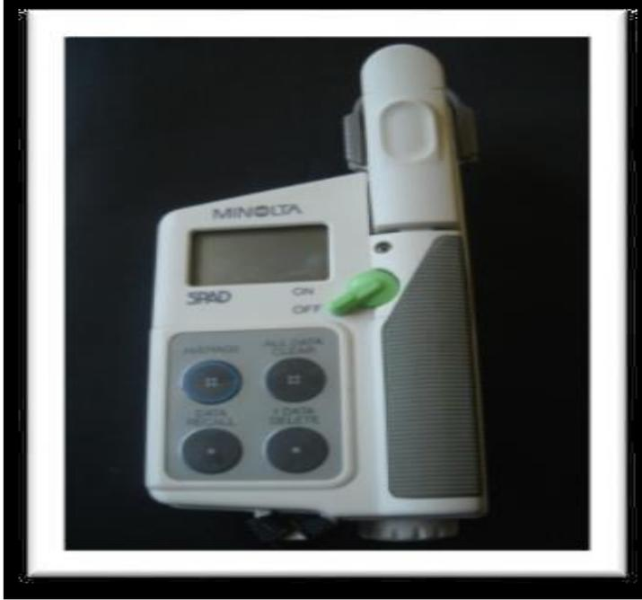
الشكل 25: صورة تبين جهاز SPAD لقياس الكلوروفيل
