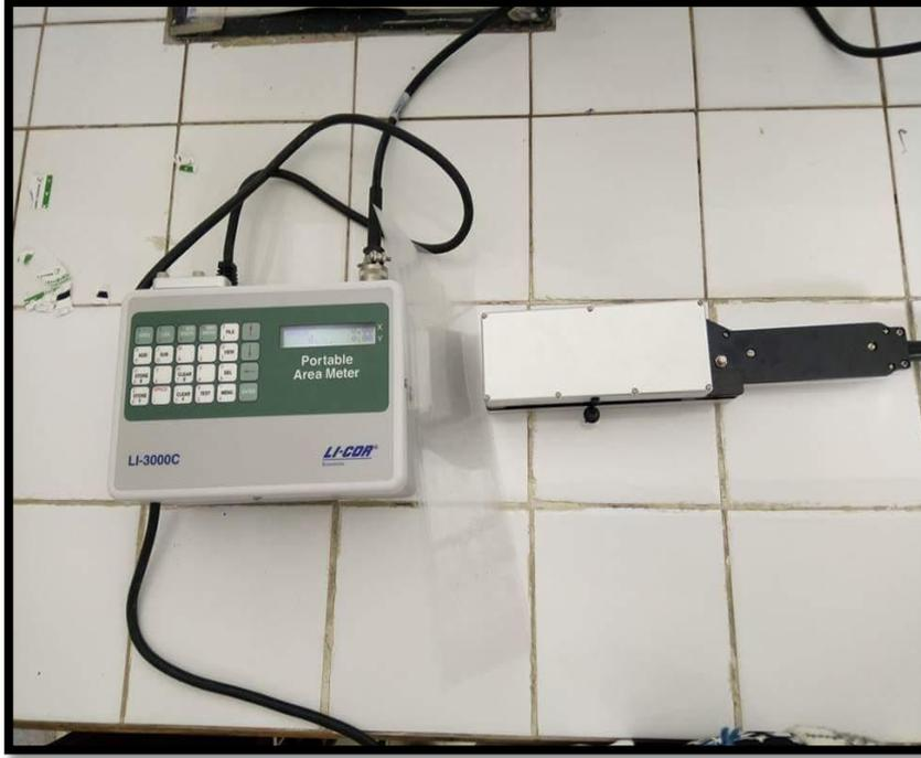
الشكل 2: صورة توضح جهاز لقياس مساحة الورقة .
